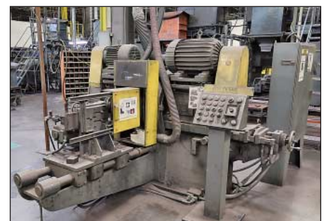
30" Dia. Gardner 120-A Twin Disc Grinder
